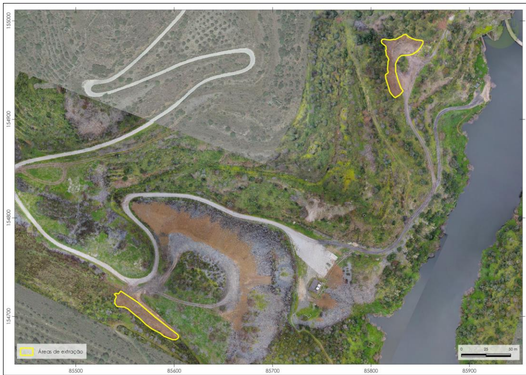
Fig. 7: Localização das áreas de extração de material para cobrir as escombreiras (09/01/2024).
