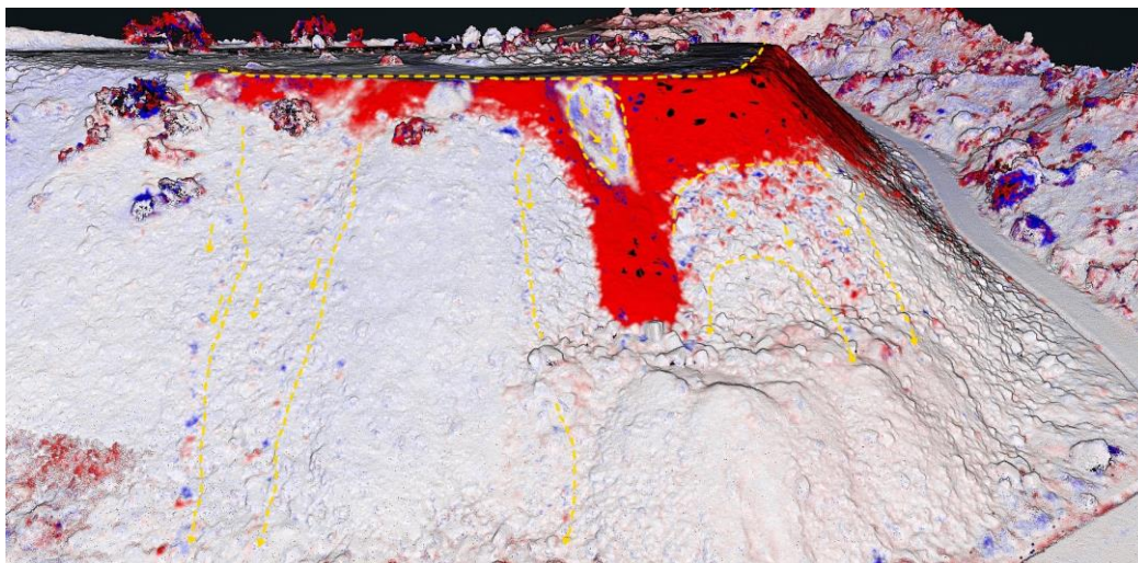
Fig. 14: Inspeção C2M demonstrando, a vermelho, a deposição de sedimentos na face da escombreira, e a indicando das trajetórias da sua escorrência, a amarelo.
