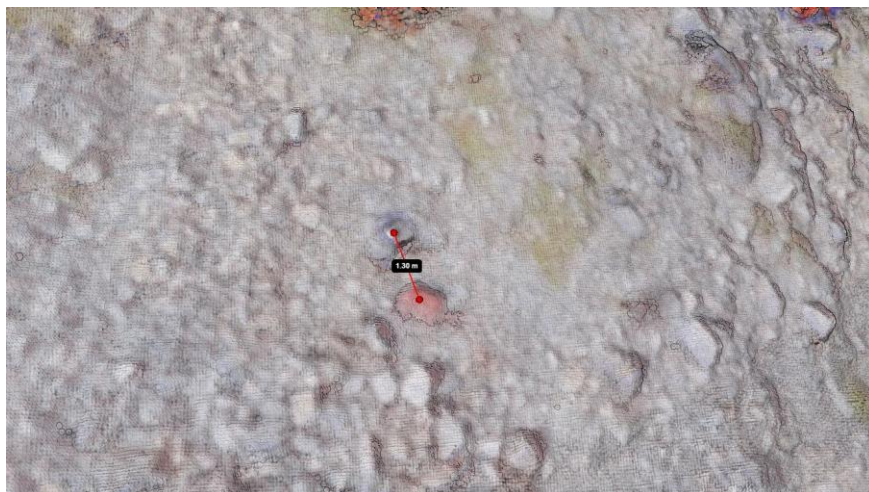
Fig. 7: Sobreposição de nuvens de pontos, com a indicação da distância do movimento do bloco em linha reta.
