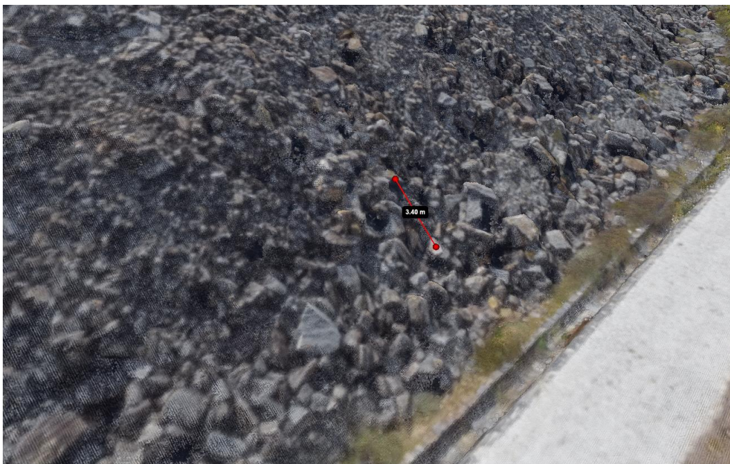
Fig. 9: Sobreposição de nuvens de pontos, com a indicação da distância do movimento do bloco em linha reta.
