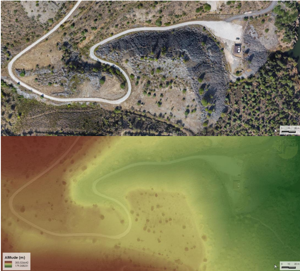
Fig. 1: Ortoimagem e modelo digital de superfície (MDS) da área da escombreira (12/09/2023).
